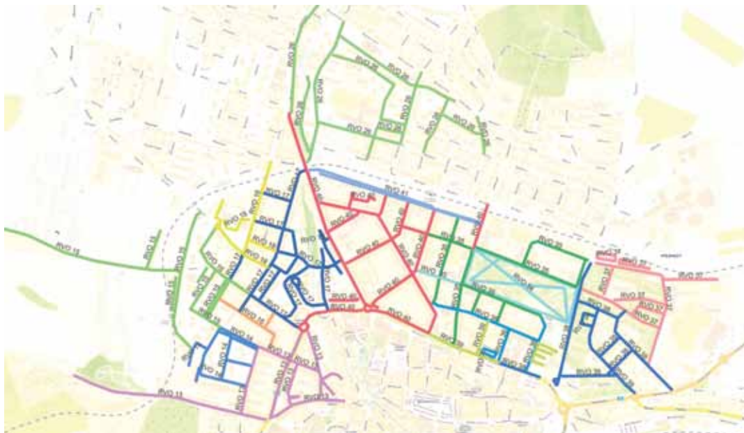
Mapa ukazuje ulice, v nichž proběhne první etapa rekonstrukce veřejného osvětlení (VO). Barevné rozlišení zvýrazňuje jednotlivé okruhy VO, které jsou napojeny na jeden rozvaděč. Zdroj: odbor územního rozvoje
