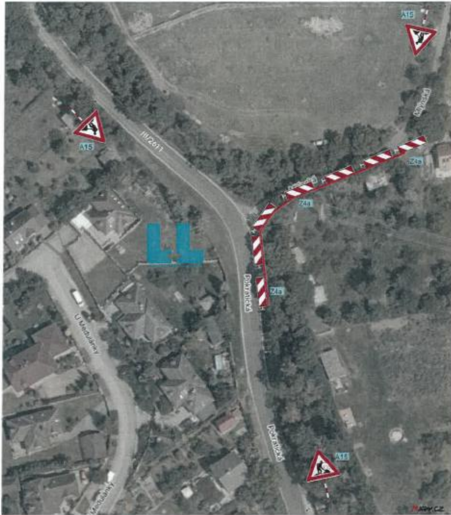
— vykop – kabelové vedení NN
