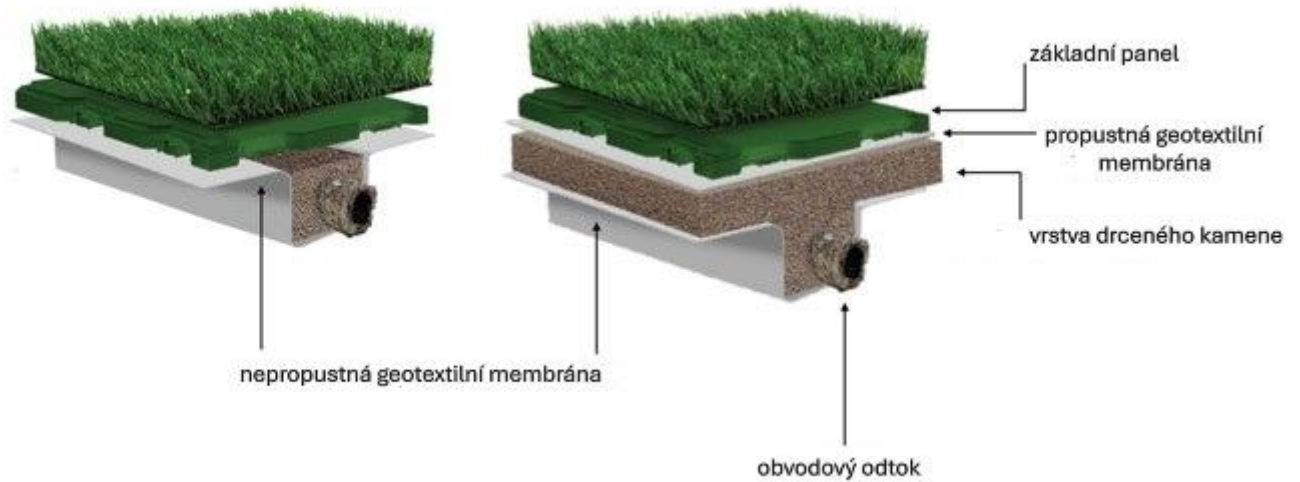
Obrázek 6 – modulární základní konstrukce – oblasti s nízkými srážkami
